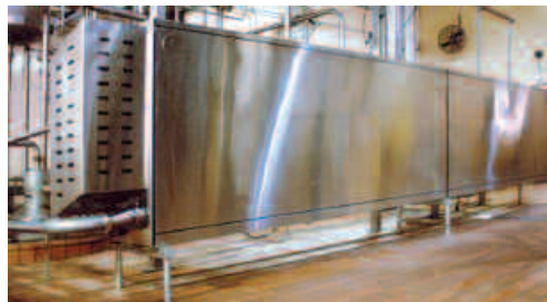
Görülen ısı değiştirici Duplex-Paslanmaz çelikten mamul olup, domates, barbekü -ızgara- ve soya sos hazırlanmasında kullanılmaktadır. Fotoğraf: Dimpleflo
