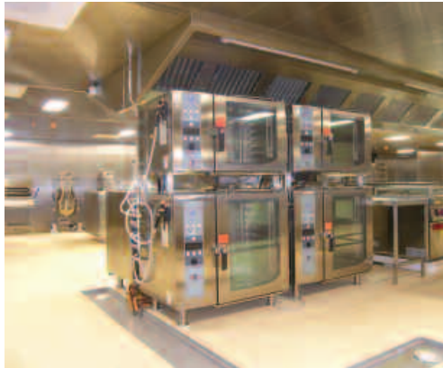
Endüstriyel mutfaklarda bulunan alet ve çalışma tezgahlarında paslanmaz çeliğin kullanımı görülmektedir. Fotoğraf : Caterform
