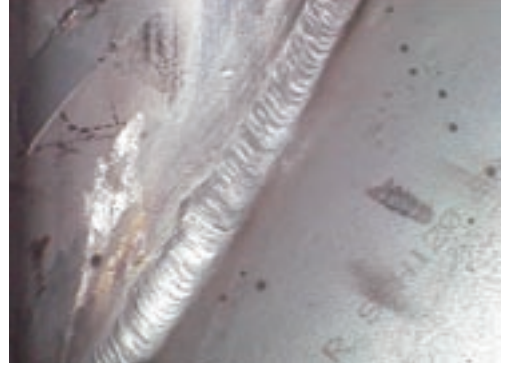
Kaynak dikişinin mekanik yüzey işlemi uygulanmış görünümü : Hedef yalnızca kabuğun alınması ve yüzeyin düzeltilmesi değil, etrafındaki renk değişikliklerinin de temizlenmesidir.
