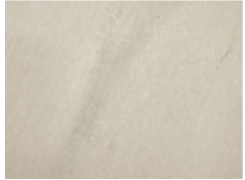
Üretici tarafından kabuk tabakası alındıktan ve asitleme yapıldıktan sonra yüzey mat gri bir renk alır. Mekanik kabuk kaldırma işlemi sonucu yüzey pürüzlü bir görünüm kazanır.
