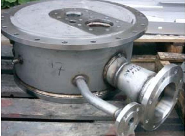
Il est important que les traces colorées dues au soudage soient supprimées des surfaces cachées des soudures sur les pièces, lorsque ces surfaces risquent d'être exposées à l'environnement d'exploitation.
