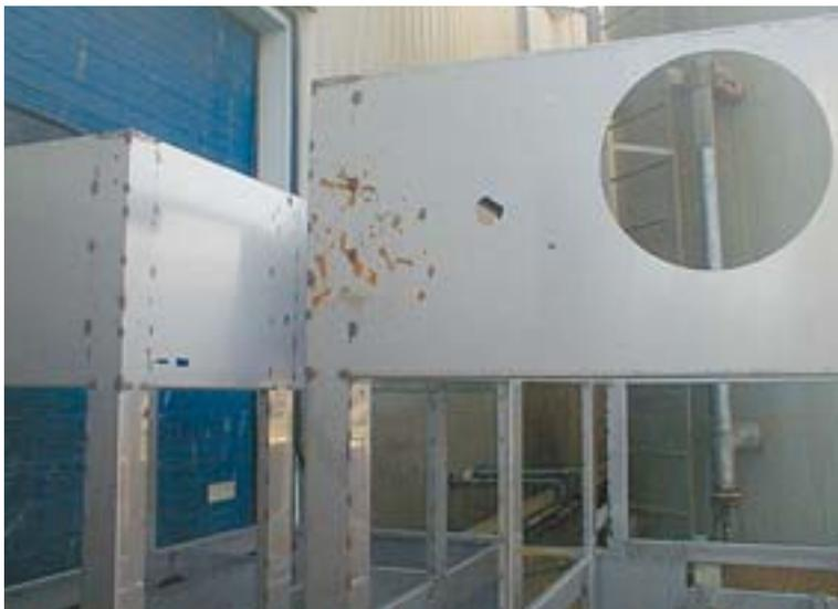
Contamination de l'acier inoxydable par le fer. L'exemple cité est un cas typique de contamination par le fer provoquée par le mélange de fer ( ou d'acier ) et d'acier inoxydable dans le même atelier, sans séparer les matériaux. Dans le procédé de décontamination, il est important que les traces de fer soient vraiment supprimées, et non pas simplement étalées.
