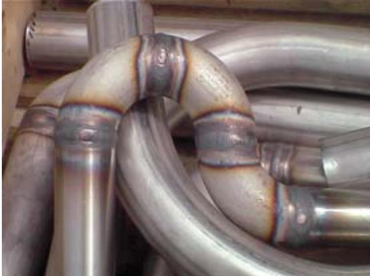
L'oxydation laissée sur les soudures et les traces colorées dues au soudage aux surfaces des tubes peuvent être supprimées par un décapage à l'acide.
