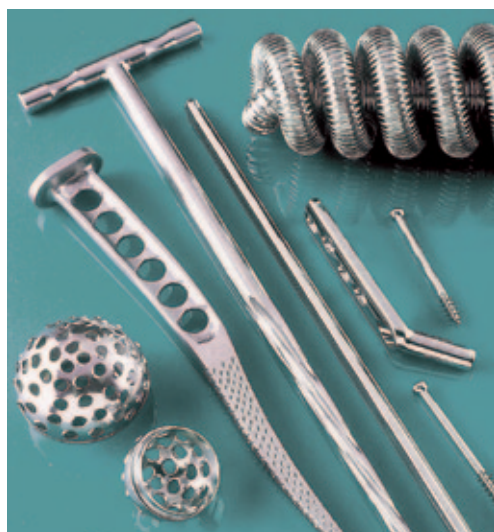
Implantáty a chirurgické nástroje jsou ve styku s korozně působícími tělesnými tekutinami a proto se korozní odolnost jejich povrchu optimalizuje elektrolytickým leštěním. Fotografie: Anopol, Birmingham (UK)
