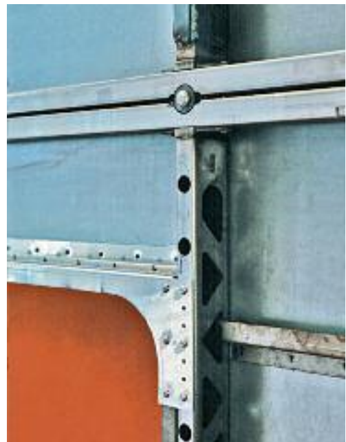
Figuur 23: In dit zijpaneel van een forensentrein zijn de constructiedelen en de buitenste panelen uit verschillende types roestvast staal gefabriceerd. Daar ze identieke potentialen hebben, kan er geen galvanische corrosie optreden.
