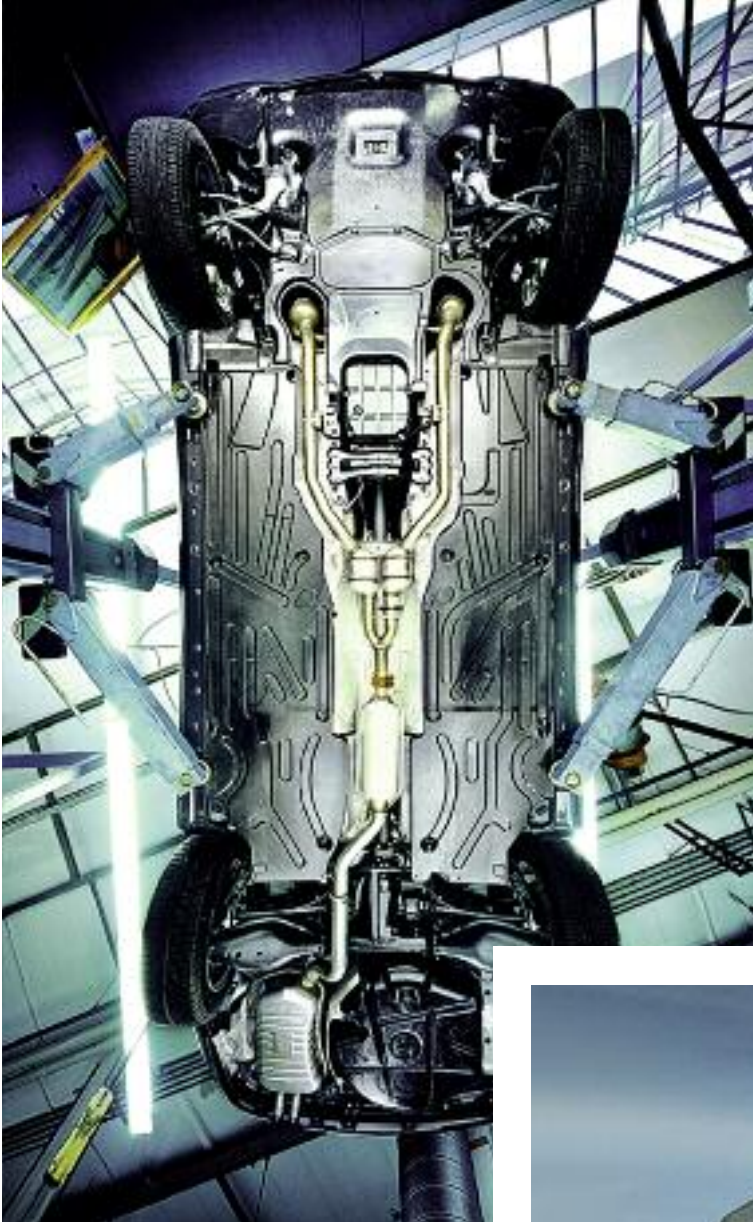
Figuur 20: Bij uitlaatsystemen voor de automotiveindustrie, is roestvast staal, een standaard keuze. De rubber delen voor de bevestigingen voorkomen galvanische corrosie.
