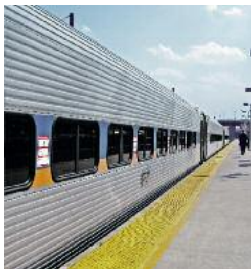
Figuur 25: Treinstellen met buitenpanelen uit austenitisch roestvast staal worden overal ter wereld gebruikt zonder problemen met galvanische corrosie.
