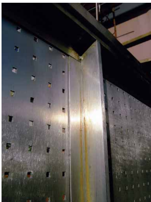
Lokální zasažení korozí bylo způsobeno částičky železa z kotouče, který byl předtím použit na uhlíkovou ocel (vlevo). Objevili se znečištění železem, může být odstraněno mořením na staveništi (vpravo) [12].
