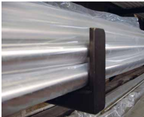
Plastový obal chrání duté profily z korozivzdorné oceli před znečištěním železem od regálů z uhlíkové oceli.
