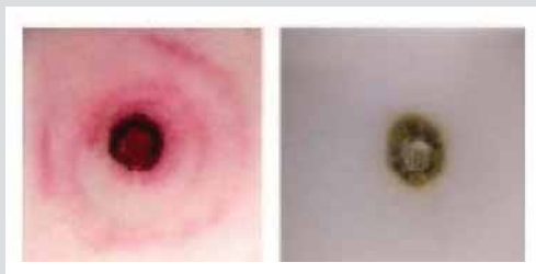
K rozlišení tříd obsahujících molybden, jako je např. 1.4401 nebo 1.4404 (vlevo) od jejich protějšku bez molybdenu 1.4301 a 1.4307 (vpravo), jsou k dispozici testovací tekutiny.
