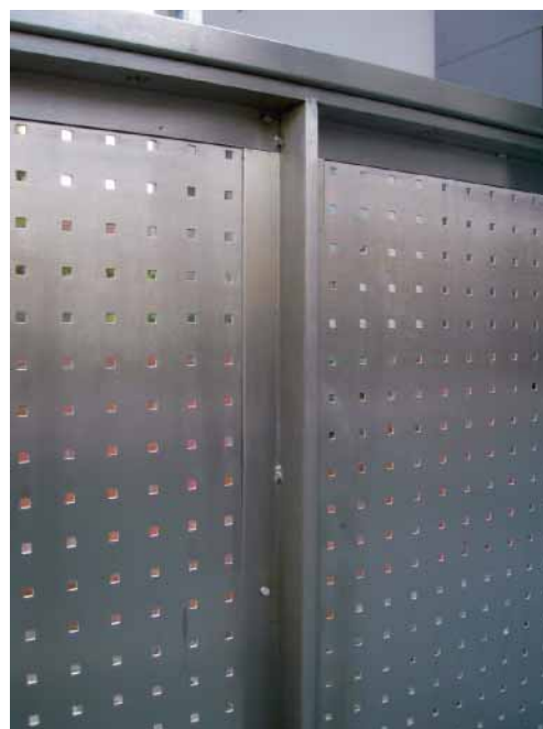
Lokální zasažení korozí bylo způsobeno částičky železa z kotouče, který byl předtím použit na uhlíkovou ocel (vlevo). Objevili se znečištění železem, může být odstraněno mořením na staveništi (vpravo) [12].
