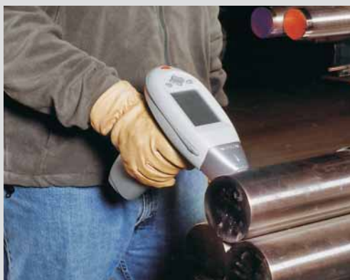
Pro úplnou analýzu slitiny jsou k dispozici speciální ruční přístroje ukazující její chemické složení.
