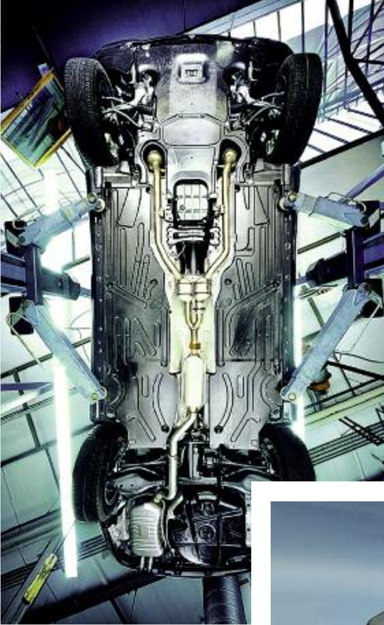
Şekil 20: Paslanmaz çelik, otomotiv egzoz sistemlerinde normal seçenektir. Bağlantı elemanlarındaki lastik parçalar, galvanik korozyonu önlemektedir.
