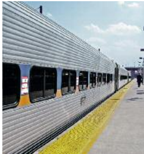
Şekil 25: Dış panelleri östenitik paslanmaz çelikten olan demiryolu yolcu vagon- ları dünyanın pek çok ye- rinde galvanik korozyon problemleri olmadan kullanılmaktadır.
