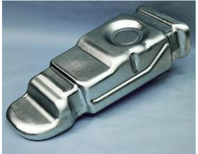
Şekil 21: Paslanmaz çelik gittikçe artan oranda yakıt tankları için kullanılmaktadır. Bunları yerinde tutan bağlantı elemanları, elektrik iletkenliğinin bağlantı yerinde kesilmesini sağlamaktadır.
