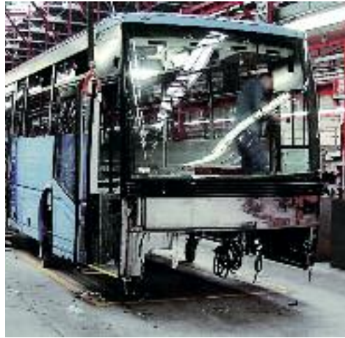
Şekil 24: Şehir içi ve şehirler arası otobüslerde kullanım için paslanmaz çelik (ge- nellikle boyalı bir ferritik kalite) karbon çeliği şasi- lerle uyumlu olduğunu ispatlamıştır.
