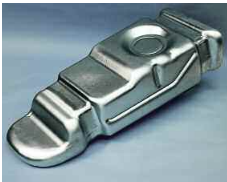
Obrázek 21: Rozšiřují se palivové nádrže z korozivzdorných ocelí. Upevňovací prvky zajišťují, aby nádrž nebyla vodivě spojena s okolní konstrukcí vozidla
