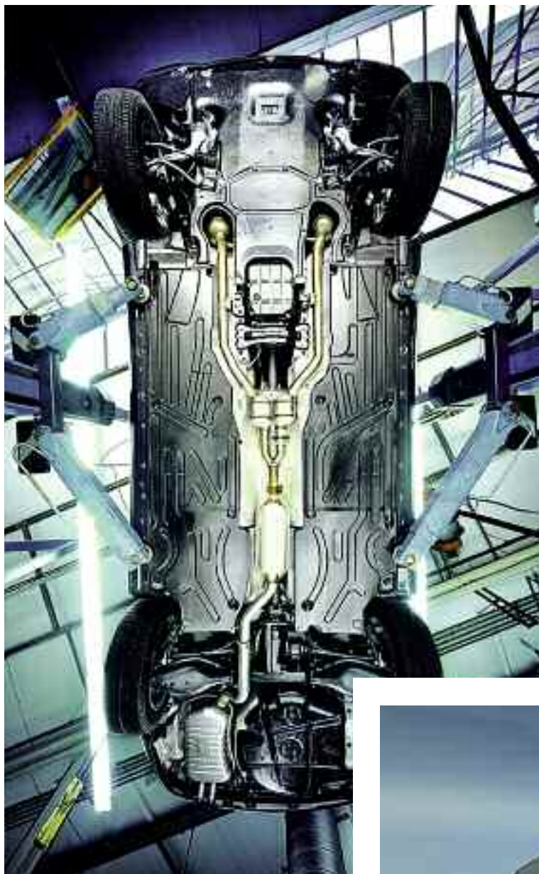
Obrázek 20: Pro výfukové soustavy automobilů se běžně dává přednost nasazení korozivzdorných ocelí. Galvanické korozi brání pryžové vložky uchyvacích prvků.
