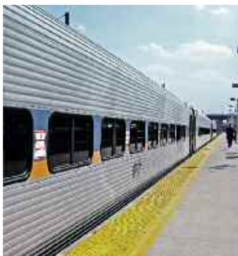
Obrázek 25: Bočnice vagonů se v mnoha částech světa vyrábějí z austenitických korozivzdorných ocelí, aniž by vznikaly problémy s galvanickou korozi.
